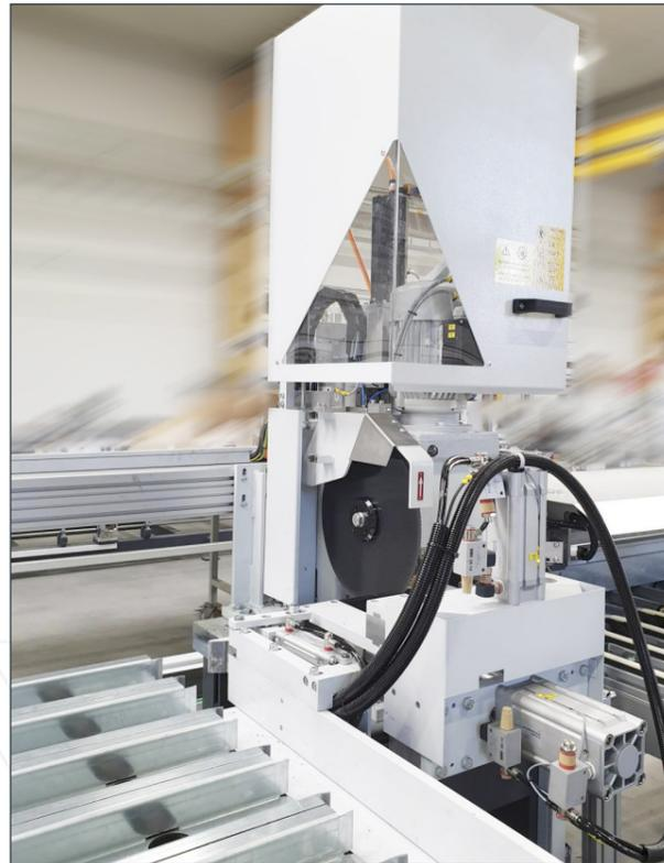
Säge mit Servo-Sägevorschub und Vario Materialspannung
