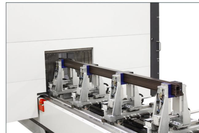
4 bzw. 8 manuell verschiebbare Spannstellen (Option: Synchrone automatische Spannstellenverschiebung)
