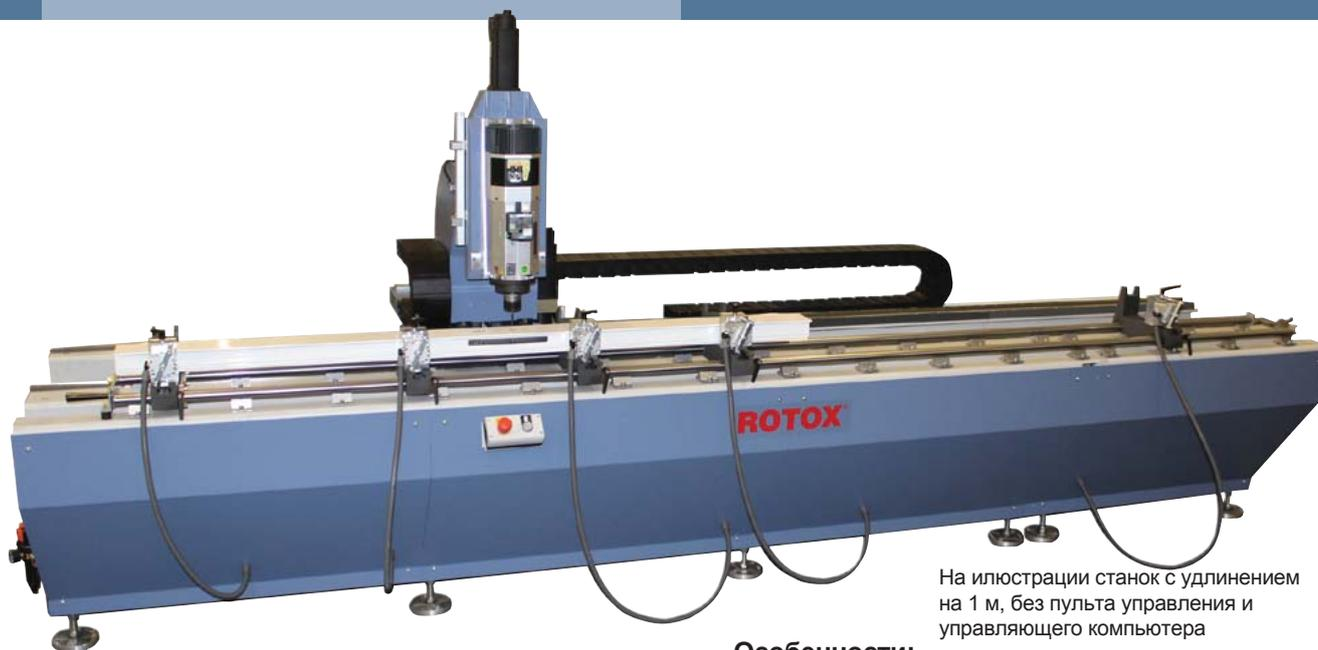
На иллюстрации станок с удлинением на 1 м, без пульта управления и управляющего компьютера
