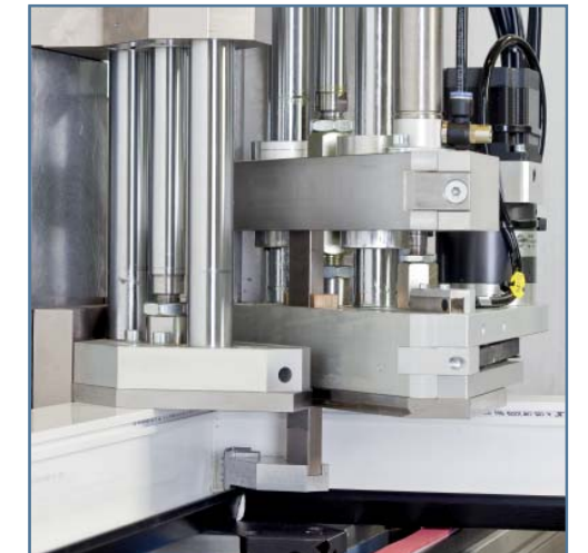
Блок формирования уплотнителя придавливает и протягивает уплотнитель
