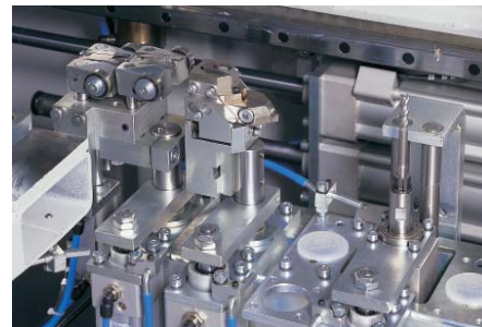
Horné a dolné obrábacie osi z každej strany po 6 miest pre nástroje.
