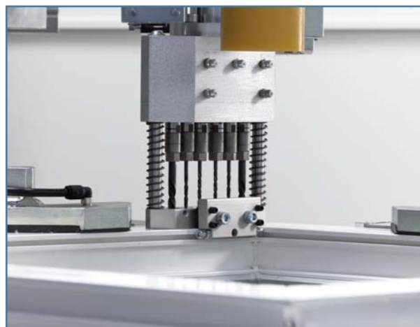
Otočný kľb na jednotke vřtania pántov s elektrickým motorom pre maximálny vřtací výkon
