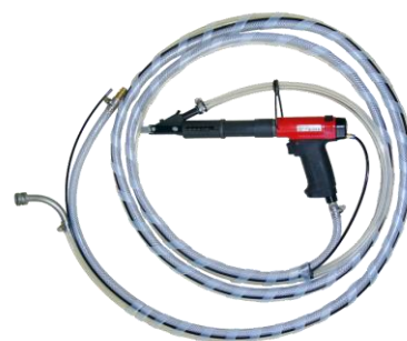
Visseuse manuelle type 93.923 pour le raccordement au dispositif de vissage automatique type MF2. Pour vis Ø 2,4 à 4,2 mm, longueur de vis de 15 à 40 mm.
