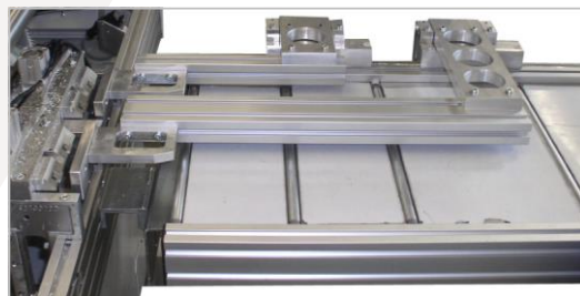
Butée de longueur LA 396-DL : 2 arrêts pour une coupe quadruple
