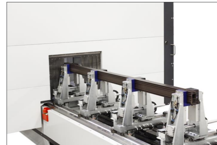
4 voire 8 positions de serrage déplacement manuel. Option : synchronisation automatique.
