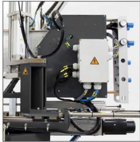
Des axes servo dynamiques contrôlent l'ensemble du processus de soudage
