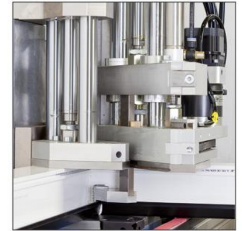
Déplacement motorisé du dispositif de pressage du joint
