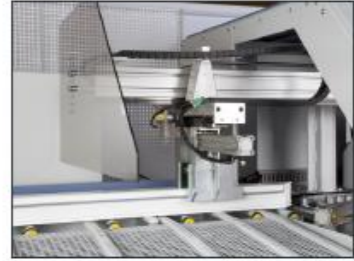
Pince pneumatique d'évacuation (Option : pilotage par CNC)
