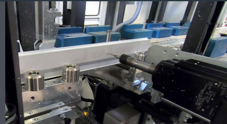
CNC-gesteuerte Fräsbearbeitung am Stab
